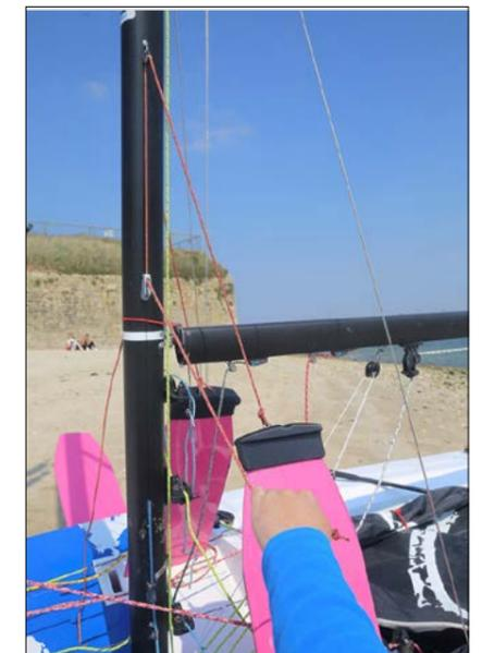
Pratique Mise à l'eau et remontée des foils sont réalisées via un pouliage frappé sur le mât avec reprise sur un taquet siffleur.
