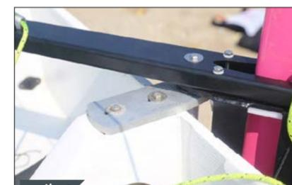
Pratique Le réglage longitudinal du plan porteur de safran s'effectue via deux boulons. Simple et efficace.
